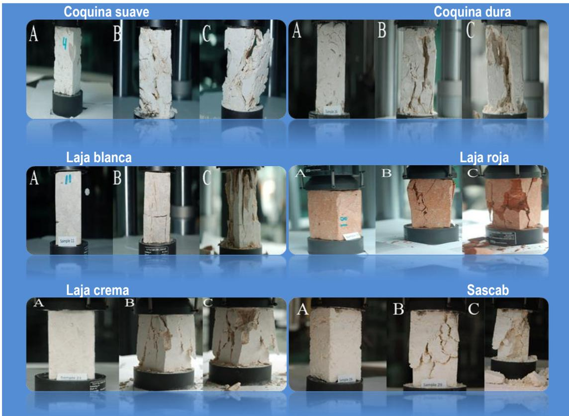
**Figura 3. Diferentes momentos durante la compresión de las muestras. (A) comienzo de la prueba; (B) parte media de la prueba; (C) final de la prueba**
